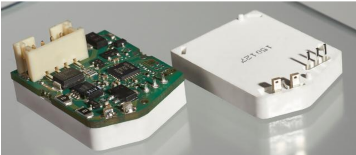
Abbildung: Beispiel ITO-Key mit Sensorfläche +Backlight und inkl. Auswertelektronik
